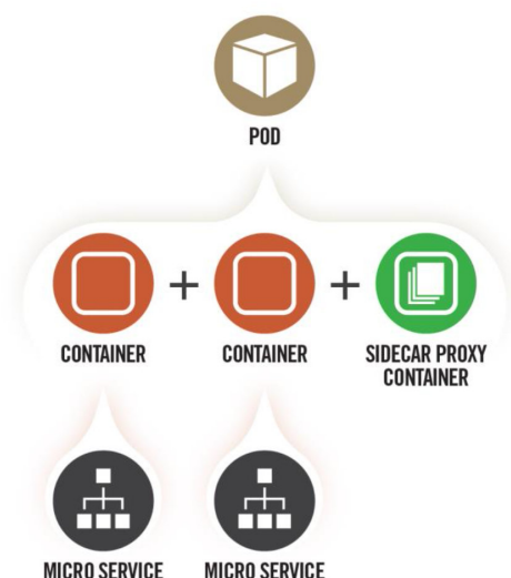
图 7-1: 有 sidecar 代理作为日志容器的 Pod 组件
